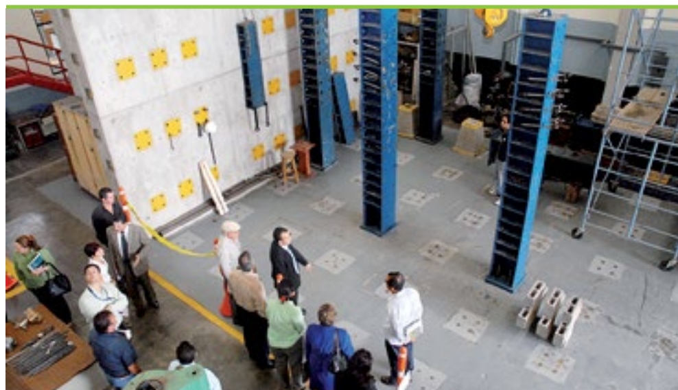
Decenas de estudiantes de ingeniería civil han realizado sus investigaciones en el piso fuerte y el muro de reacción del Lanamme (foto Archivo ODI).
